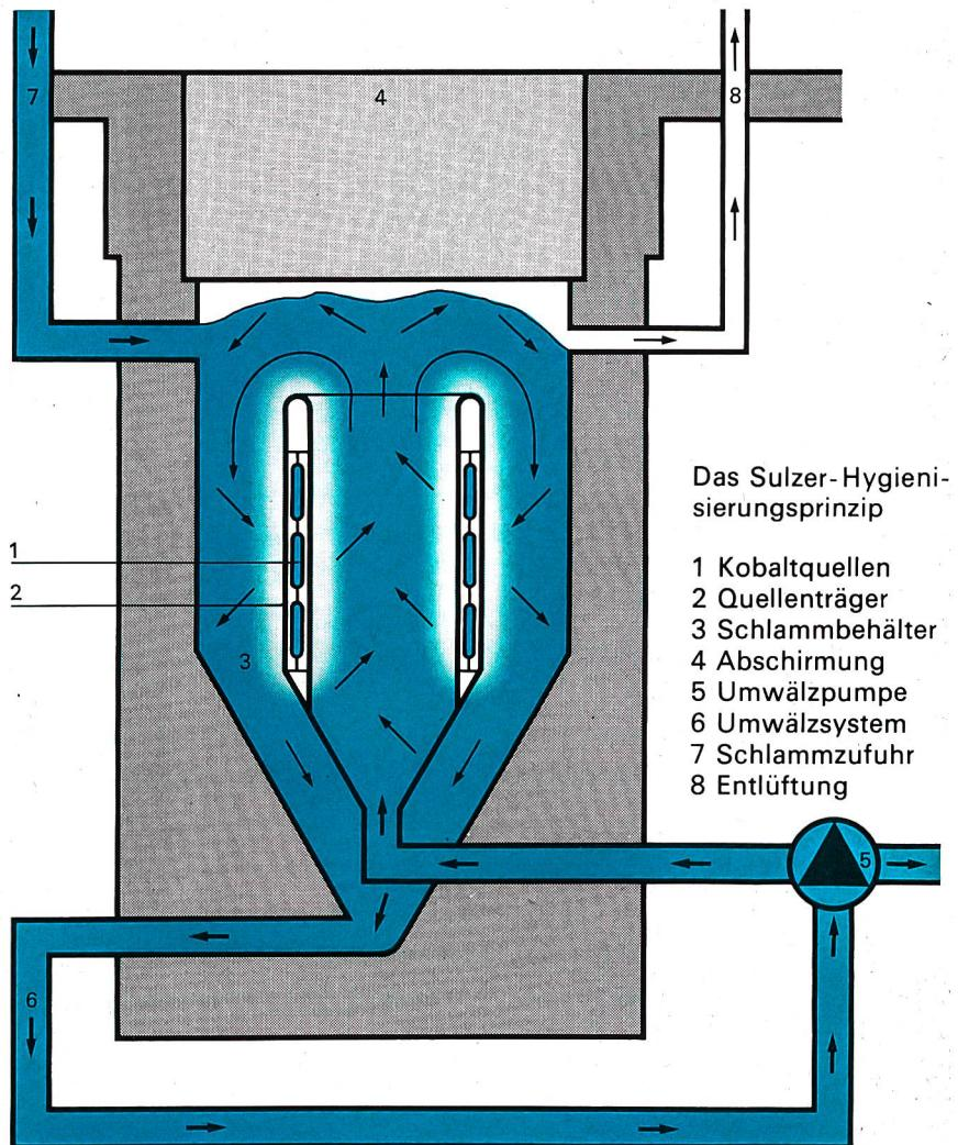
Das Sulzer-Hygienisierungsverfahren mit Gammastrahlen ist sehr einfach. Die Anlagen sind absolut strahlensicher konstruiert und erfordern kein zusätzliches Bedienungspersonal. Die Aktivierung des Schlams durch Bestrahlung ist aus physikalischen Gründen ausgeschlossen.
