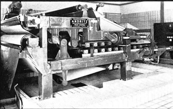
auch bei diffizilen Schlammtypen durch Betriebs- und Versuchsergebnisse garantiert. Die ANDRITZ SEM, als Langsamläufer konzipiert, ist durch ihren kontinuierlichen und vollautomatischen Betrieb niedrig in den Betriebskosten und zeichnet sich durch lange Lebensdauer aus.
