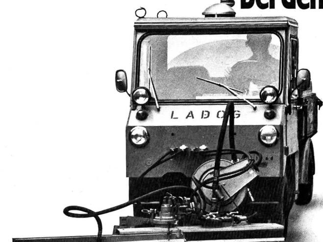
Verschiedene Fahrzeugtypen der Kat. A stehen zur Wahl. Allradantrieb, Allradlenkung, Allradfederung, vollsynchrone Getriebe, unterschiedliche Radstände (gilt auch für Ladebrücken).
