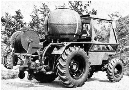
Das grösste Modell ist der Aufsatz-Salz- und Splittstreuer AMA 60B Inhalt 6 m 3 .
