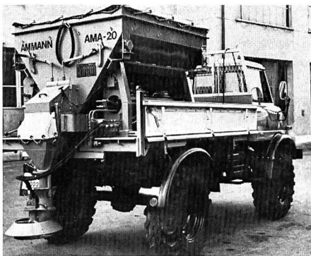
Aufsatz-Salz- und Splittstreuer AMA-20A und 30A Inhalt 2 m 3 und 3,6 m 3
