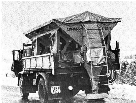
Das grösste Modell ist der Aufsatz-Salz- und Splittstreuer AMA 60B Inhalt 6 m 3 .
