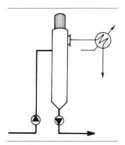
An die Reaktionsstufe anschliessend wird das Polymer in Schmelze dem Dünnschichtverdampfer zugeführt. Dieser behandelt das Produkt unter Vakuum, entfernt die unerwünschten Anteile von Caprolactam, Olygomeren sowie Wasser und erreicht eine Endkonzentration wasserlöslicher Anteile je nach Forderung zwischen 1 und 5  $^{0}/_{0}$ . Das erhaltene Produkt weist Viskositäten von mehr als 300 P auf. Farbe und Qualität sind hervorragend.
