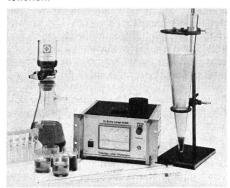
Zur Kompensation eventueller Störgrössen wie Lampenalterung oder einer eventuellen Farbbeeinflussung erfasst ein Vergleichswiderstand nach dem Absorptionsprinzip diese Störgrössen.
