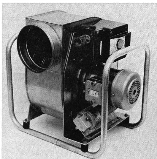
**Technische Daten:** Fördermenge: 40 m<sup>3</sup>/min ohne Anschluss-Schlüsse; 33 m<sup>3</sup>/min bei einem Schlauch von 7,5 m Länge; 29 m<sup>3</sup>/min bei 2 Schläuchen von je 7,5 m Länge. Einphasenmotor 220 Volt, 50 Hz mit Kondensator und Motorschutzschalter, notwendige Absicherung 6 Amp. (Lichtsteckdose), Gesamtgewicht 28 kg.
