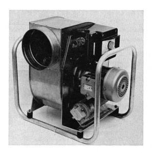
**Technische Daten:** Fördermenge: 40 m³/min ohne Anschluss-Schläuche; 33 m³/min bei einem Schlauch von 7,5 m Länge; 29 m³/min bei 2 Schläuchen von je 7,5 m Länge. Einphasenmotor 220 Volt, 50 Hz mit Kondensator und Motorschutzschalter, notwendige Absicherung 6 Amp. (Lichtsteckdose), Gesamtgewicht 28 kg.
