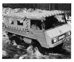
Der Pinzgauer zeichnet sich nicht nur durch den niedrigen Oktanbedarf von 87 ROZ, sondern auch durch eine ausgesprochen flache Drehmoment-Kennlinie aus, wobei das maximale Drehmoment von 18 mkp schon bei 200 U/min erreicht wird. Er zeichnet sich durch Anspruchslosigkeit, Härte im Nehmen, bemerkenswerte technische Lösungen und extreme Geländetauglichkeit aus.
