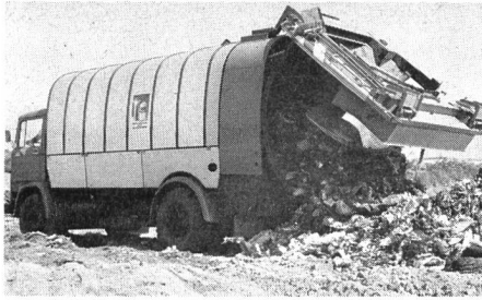
Abb. 3. Kuka-verdichteter Kehrrecht beansprucht in der Deponie weniger Volumen und verrottet schneller
