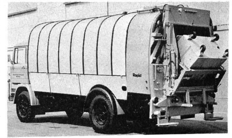
Abb. 1. Kuka-Müllwagen sind in jedem Falle mit einer Container-Schüttung versehen. Dank dem steilen Einkippwinkel können die Behälter mühelos entleert werden
