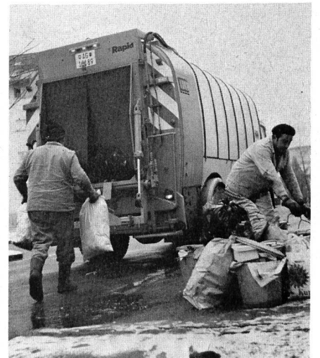
Abb. 2. Kuka-Müllwagen eignen sich besonders für gemischte Abfuhr, wie es in der Schweiz meist der Fall ist. Durch die kontinuierliche Belademöglichkeit lassen sich die Arbeitszeiten beträchtlich verkürzen
