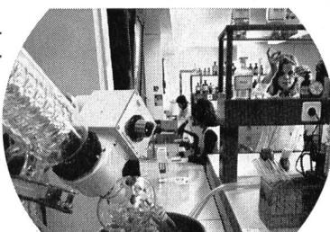
**3.** Sinnvolle, moderne Laboreinrichtungen für speditive Analysen innert Stunden bei dringenden Sanierungsmassnahmen, speziell bei Ölunfällen (sofortige Extraktionen und IR-Messungen der Kohlenwasserstoffgehalte).
