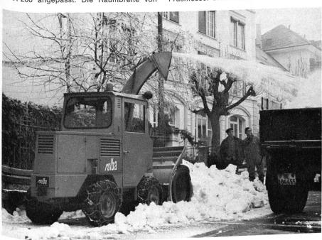
Lenkung der Hinterachse). Die Maschine verfügt über zwei wählbare Fahrantriebe: Mit Hydrostat stufenlos vor- und rückwärts oder mechanisch über ein 6-Gang-Getriebe mit zwei Rückwärtsgängen. Die Kabine ist mit einer wirkungsvollen Warmluftheizung ausgestattet, und die gute Sicht nach vorn wird durch eine Therglas-Frontheizscheibe gewährleistet.
