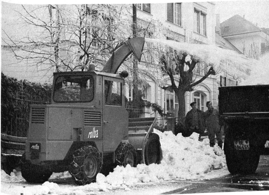
Abb. 1. Schematische Darstellung des Rolba-Schneefrösschleuderprinzips. Vorn die geschwungenen Frössmesser, dahinter das mit der rund doppelten Tourenzahl der Frössmesser drehende Schleuderrad
