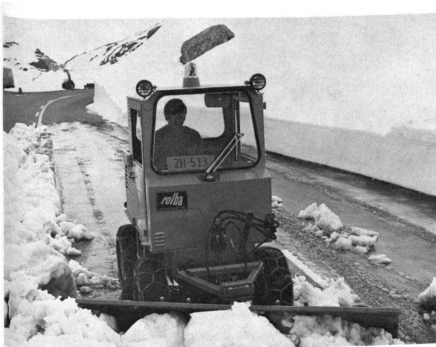
Abb.3. Rolba R-200 mit Schneepflugvorbau, Räumbreite 180 cm, Höhe 72 cm, hydraulische Steuerung aller Bewegungen
