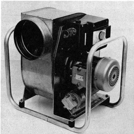
**Technische Daten:** Fördermenge: 40 m<sup>3</sup>/min ohne Anschluss-Schläuche; 33 m<sup>3</sup>/min bei einem Schlauch von 7,5 m Länge; 29 m<sup>3</sup>/min bei 2 Schläuchen von je 7,5 m Länge. Einphasenmotor 220 Volt, 50 Hz mit Kondensator und Motorschutzschalter, notwendige Absicherung 6 Amp. (Lichtsteckdose), Gesamtgewicht 28 kg.
