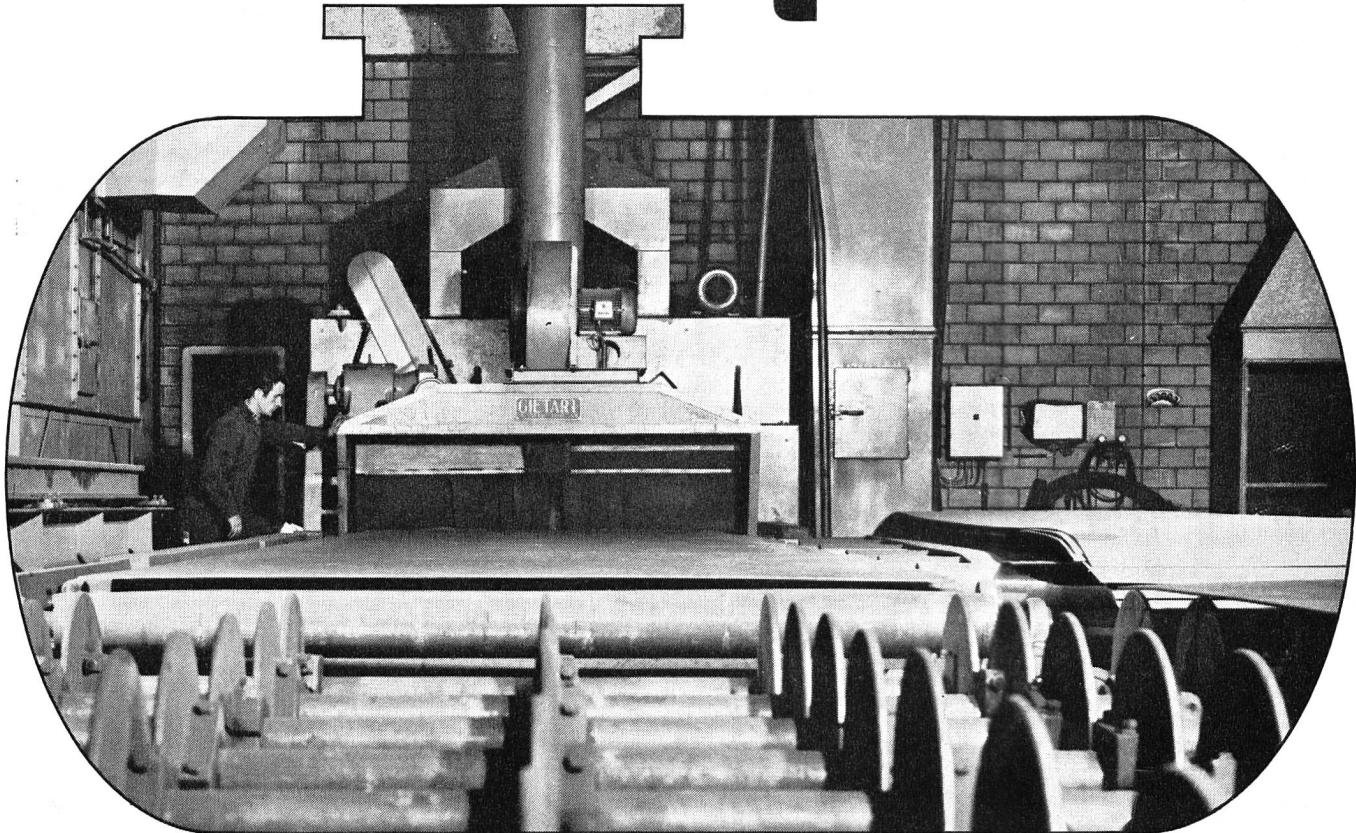
«Sandgestrahlt» ist bei uns Standardqualität. Ohne Mehrpreis. Jedes Teilstück, gleichgültig ob für zylindrische oder ob für kubische Tanks wird vor dem Zusammenbau sandgestrahlt. Eine unserer beiden Anlagen sehen Sie hier auf der Abbildung.
