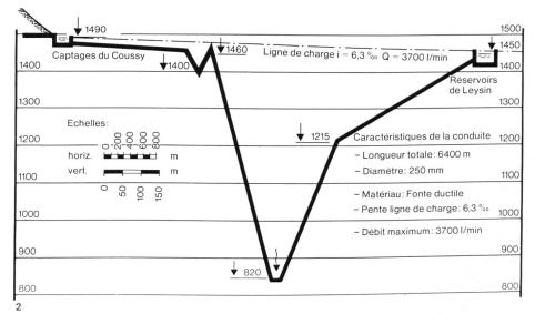
Abb. 2. Längsprofil
