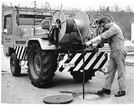
Abb. 1. Hydromat-Bimotra, die selbstfahrende Hochdruck-Kanalreinigungsmaschine der Firma Birchmeier, Künten
