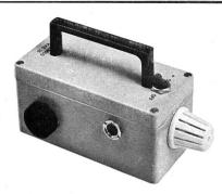
robust und handlich schlagfestes, wasserdichtes Gehäuse nur ein Bedienungselement Betriebskontrolle und Warnsignal akustisch netzunabhängig, aufladbar lieferbar für verschiedenste Gase und Dämpfe
