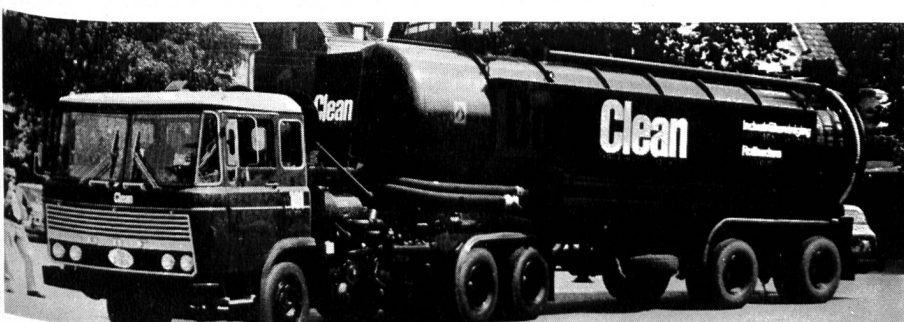
Abb. 13. Recht eindrücklich zeigt die Abbildung den Trend zum Grossfahrzeug. Es handelt sich um einen Eichhoff-Schlamm-saugwagen-Sattelaufliager Typ 26 000 mit DAF-Sattelzugmaschine Typ FAT 2600 DK 460. Schlammbehälter 26 000 l Fassungsvermögen, ausgelegt als Druckbehälter; mit zentral-verriegelter Entleerungsklappe; Entleerung durch hydraulische Kippvor-
