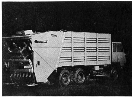
Abb. 3. Der im In- und Ausland patentierte Mammut-Kehrichtaufbau auf 3-Achs-Chassis Steyr mit Kasteninhalt 20 m 3 für Kehrichteimerentleerung, Gemischtabfuhr, Sackeinwurf, Sperrgutabfuhr und Container-Entleerung (Aufnahme). Ladefähigkeit rund 110 m 3 oder 12 t Haushaltkehricht
