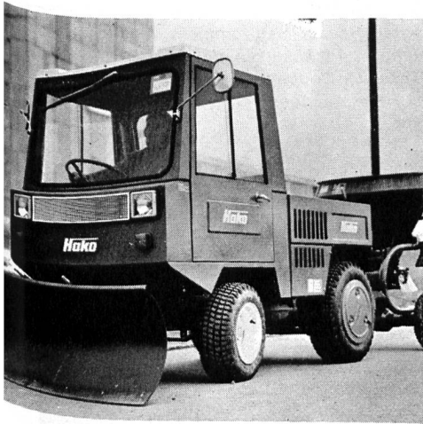
Abb. 4. Kleinfahrzeug Hakomobil 4000. Mit einer Gesamtlänge von 2500 mm und einer Breite von 1180 mm wurde das «Hakomobil 4000» so klein wie möglich gehalten. Trotz des massiven Stahlrahmens und der kompakten, robusten Bauweise ist sein Eigengewicht mit 800 kg relativ niedrig
