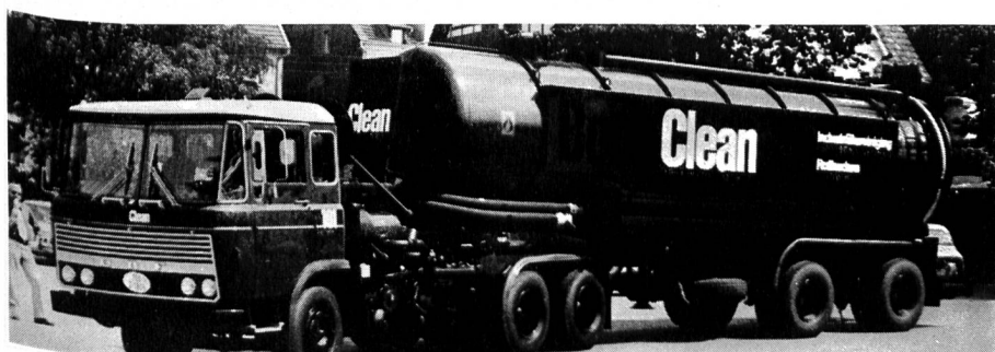
Abb. 13. Recht eindrücklich zeigt die Abbildung den Trend zum Grossfahrzeug. Es handelt sich um einen Eichhoff-Schlamm-saugwagen-Sattelaufleger Typ 26 000 mit DAF-Sattelzugmaschine Typ FAT 2600 DK 460. Schlammbehälter 26 000 l Fassungsvermögen, ausgelegt als Druckbehälter; mit zentral-verriegelter Entleerungsklappe; Entleerung durch hydraulische Kippvor-
