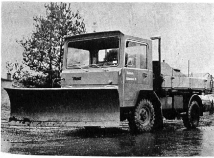
Abb. 2. Trend zum kleinen Fahrzeug, am Beispiel des Meili MA 1500 demonstriert: Kommunalfahrzeug mit angebaurem Schneepflug. Allrad-Kipper Kategorie A. Nutzlast etwa 1100 kg. Für extreme Verhältnisse und strengen Winterbetrieb. Chassis für Spezialaufbauten und Anbaugeräte aller Art geeignet
