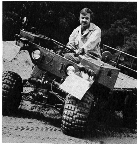
Abb. 5. Im Kommunalfahrzeugsektor noch weitgehend unbekannt, der Faun Kraka 640. Das moderne Fahrzeug, das nun in Serie gebaut wird, ist nicht nur für den militärischen Einsatz gedacht, es vermag vielmehr zahlreiche Anforderungen im Kommunalbereich zu erfüllen. Das Leichtfahrzeug wird durch einen 700-cm 3 -BMW-Boxermotor angetrieben, Leistung 26 PS. Charakteristisch ist die hohe Nutzlast von 870 kg gegenüber einem Leergewicht von 740 kg. Der «640» hat eine Steigfähigkeit von 55% und ist voll geländegängig. Durch eine ideale Fahrwerkskonstruktion liegen die hinteren Antriebsräder immer mit annähernd gleichem Bodendruck auf
