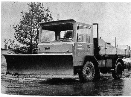
Abb. 2. Trend zum kleinen Fahrzeug, am Beispiel des Meili MA 1500 demonstriert: Kommunalfahrzeug mit angebaute Schneepflug. Allrad-Kipper Kategorie A. Nutzlast etwa 1100 kg. Für extreme Verhältnisse und strengen Winterbetrieb. Chassis für Spezialaufbauten und Anbaugeräte aller Art geeignet
