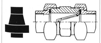
Schraubenventile mit Nennweiten von %'' bis 2%'' Flanschventile mit Nennweiten von 25 bis 250 mm  $\varnothing$
