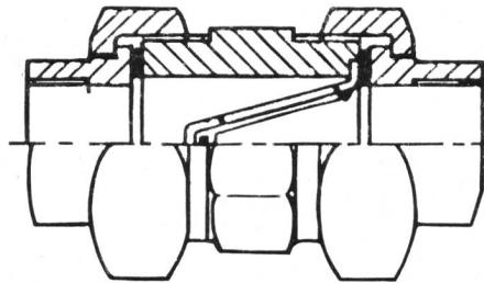
Schraubenventile mit Nennweiten von  $\frac{1}{2}''$  bis  $2\frac{1}{2}''$
