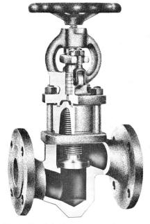
Abb. 3. Ein Beispiel aus dem Bereich Armaturen von KSB: Panzer-Ventil mit Faltenbalg (Abbildungen 1 bis 3: KSB)
