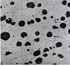
Abb. 3. Spannungsverlauf bei verschiedener Lage und Form der Graphitteilchen
