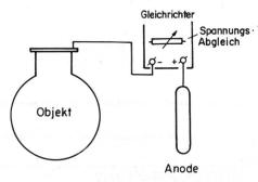
Abb. 3. Anordnung einer kathodischen Schutzanlage mit Gleichrichter
