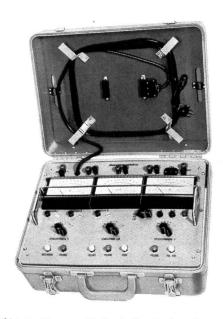
Abb. 6. Messgerät für kathodischen Korrosionsschutz
