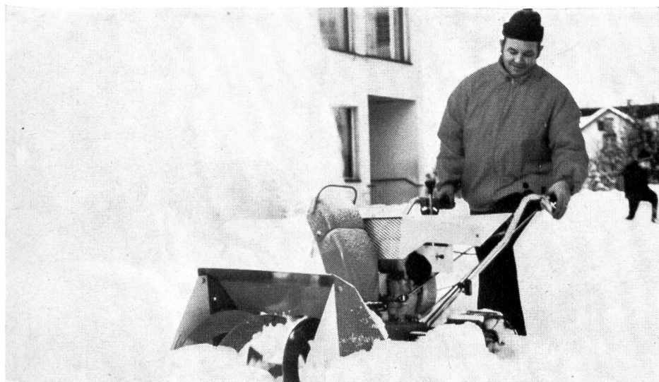
Abb. 3. Die Unitrac-Combi-Schneesleuder lässt sich ohne Werkzeuge minutenschnell in einen Sichelmäher, Salz- und Düngerstreuer, Abfall- und Laubsauger sowie in einen Grossflächenwischer umstellen ▼
