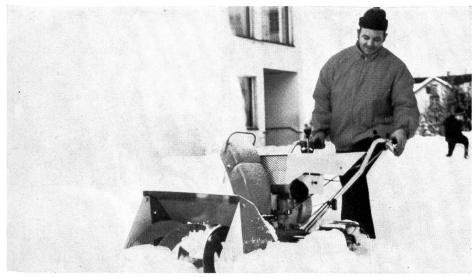
Abb. 3. Die Unitrac-Combi-Schneeschleuder lässt sich ohne Werkzeuge minutenschnell in einen Sichelmäher, Salz- und Düngerstreuer, Abfall- und Laubsauger sowie in einen Grossflächenwischer umstellen
