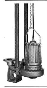
BRUNNER Tauchpumpen fördern Fäkalien, Abwasser und Schlamm. Ausgerüstet mit dem bewährten Wirbelrad sind sie deshalb verstopfungsfrei. Zwei, in Oelbad laufende Gleitringdichtungen, schützen den Motor.
