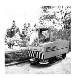
Strassen geholt, unebene Strassen sind für die Rapid 10 kein Hindernis. Von grösster Bedeutung ist, dass mit diesem Aufnahme-prinzip die äusserst giftigen Abriebteilchen von Autoreifen und Strassenbelag, die mit Oel- und Abgas gesättigt sind, restlos aufgenommen werden.
