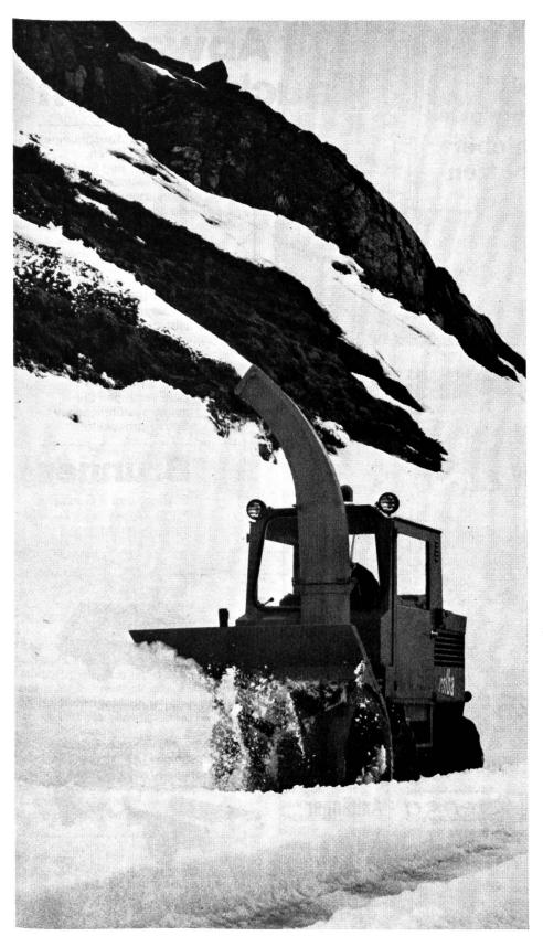
Abb. 8. Nicht zu gross, aber auch nicht mehr zu den «Kleinen» zu zählen: das Modell R-200 mit einem 66-PS-Volkswagenmotor
