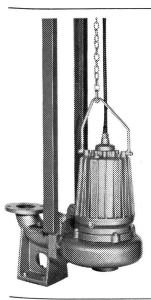
BRUNNER Tauchpumpen fördern Fäkalien, Abwasser und Schlamm. Ausgerüstet mit dem bewährten Wirbelrad sind sie deshalb verstopfungsfrei. Zwei, in Oelbad laufende Gleitringdichtungen, schützen den Motor.
