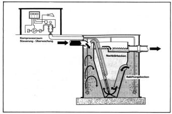
Querschnitt durch die MWB Gruppen-Reinigungsanlage
