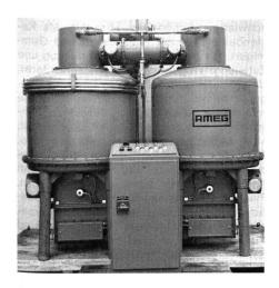
Abb. 2. Ameg-Aktivkohleanlage Typ 960 e D A. Vollautomatisch-programmgesteuerte Doppelanlage mit angebautem elektrisch beheiztem Koppelverdampfer
