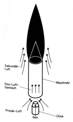
Abb. 7. Prinzipschema eines Injektorbrenners
