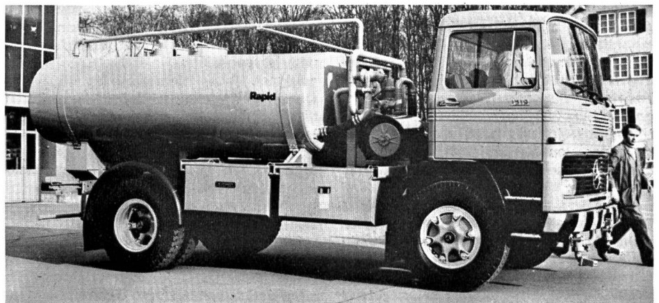
Abb. 7. Der komplett elektrifizierte und daher besonders umweltfreundliche Waschwagen, ausgerüstet mit einem 6800 l fassenden Kunststofftank
