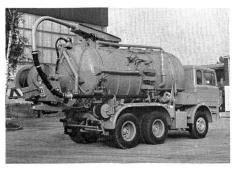
Abb. 6. Ein Kombifahrzeug, für die Hochdruckreinigung wie als Schlammsaugefahrzeug gleichermassen geeignet, mit 12 m³ Inhalt
