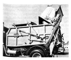
Abb. 4. Schlachtmüllwagen mit Ueberkopf-Containerentleerung: Eine hygienisch einwandfreie Lösung
