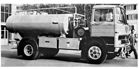
Abb.7. Der komplett elektrifizierte und daher besonders umweltfreundliche Waschwagen, ausgerüstet mit einem 6800 I fassenden Kunststofftank
