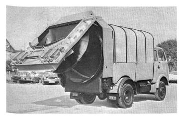
Abb. 2. Der Kleinste: der Kuka-Mini-Müllwagen mit 6 m³ Inhalt
