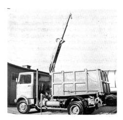
Abb. 3. Das Kuka-Konfiskat-Fahrzeug, ausgerüstet für eine Beladung mittels Kran
