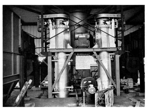
ne Speisepumpe in den Kessel gefördert wird; auf diese Weise bilden Dampfkessel, Dünnschichttrockner, Lufterhitzer und Kondensator ein geschlossenes System.
