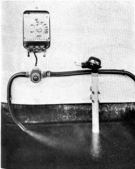
automatische Polymetron-Wasserspargerät macht sich schon in kurzer Zeit bezahlt. Es entlastet die Mitarbeiter durch präzise Überwachung des Spülades, reduziert den Frischwasserverbrauch, verhindert die bei Spülwassereinschaltung durch Hand- oder Fußschalter möglichen unzureichenden Spülungen, vermeidet unzulässige Verschmutzungen im Spülbad, entlastet die Abwasserreinigungsanlage und reduziert den Chemikalienverbrauch für die Abwasseranlage.
