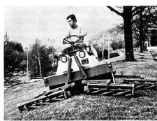
te ist von 208 bis 338 cm variabel, weil die Mähaggregate teilweise einzeln einschaltbar sind. Die Schnitthöhenverstellung von 10 bis 76 mm erfolgt ohne Werkzeug durch einfaches Nachstellen der Gleitschuhe. Der «Super Turf King» mäht pro Stunde bis zu 15 000 m² Rasen gleichmässig und teppichweich. Robuste Konstruktion, einfache Wartung, minimale Unterhaltskosten und sparsamer Benzinverbrauch machen den erprobten Grossflächenmäher zum wirtschaftlichen Arbeitsinstrument für kommunale Betriebe.
