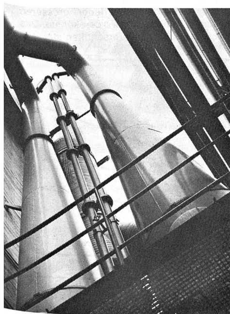
Abb. 2. Luftwäscher im Einsatz in der chemischen Industrie
