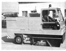
Abb. 1. Vollhydraulische Kehrmaschine Tecko, Modell SAM 2000. Kehrbreite einstellbar von 1600 bis 2100 mm, Kehrleistung bis 20 000 m²/h, Aufnahmevolumen 1500 l, Auskipphöhe des Schmutzbehälters 1320 mm (Generalvertretung für die Schweiz: Robert Aebi AG)
