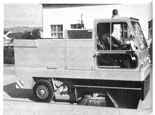
Abb. 1. Vollhydraulische Kehrmaschine Tecko, Modell SAM 2000. Kkehrbreite einstellbar von 1600 bis 2100 mm, Kkehrleistung bis 20 000 m 2 /h, Aufnahmevolumen 1500 l, Auskipphöhe des Schmutzbehälters 1320 mm (Generalvertretung für die Schweiz: Robert Aebi AG)
