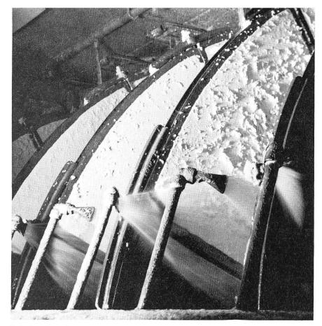
Scheibenfilter: Der Filterkuchen wird abgespritzt
