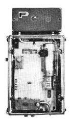
Chlorüberschussmessgerät Modell N17B2300
