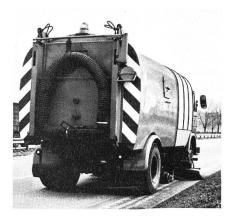
10 m³ und eine Nutzlast von 6—10 Tonnen und kehrt rechts oder links mit einer Kehrgeschwindigkeit bis zu 20 km/h. Sie wurde speziell für die Sauberhaltung von Autobahnen, Schnellund Autobahnauffahrten entwickelt.
