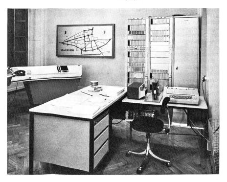
spricht auch der modernen Entwicklung der Datentechnik, die Nachrichtenübertragung im Zeitmultiplex vorzunehmen. Ein nach diesen Prinzipien arbeitender Verkehrsrechner ist beispielsweise der Hasler CONTRA (CONtrol of TRAffic), der in Bern, Zürich und Sitten (Abb. 3) eingesetzt wurde und in kurzer Zeit den Verkehr in Lugano und Neuenburg leiten wird. Abb. 4 zeigt den neuen Verkehrsregelungsplan von Lugano.
