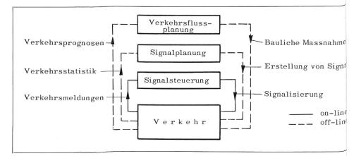
Abb. 1. Regelkreise für Planung und Steuerung des Strassenverkehrs
