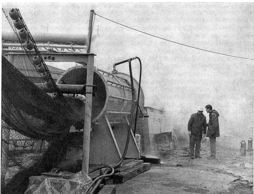
Fig. 2. Une des lessiveuses automatiques inventées par les savants du ministère des Pêches et des Forêts pour nettoyer les filets de pêche imbibés de mazout
