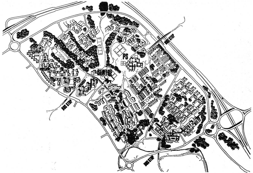
Abb. 4. Sektor 1, Nachbarschaft 1. Unbebaubares Land und landschaftlich besonders wertvolle Zonen bestimmen hier den Verlauf des Grünzuges. Die Ueberbauung ist gemischt, es überwiegt die Clusterbauweise mit eingeschossigen Blöcken
