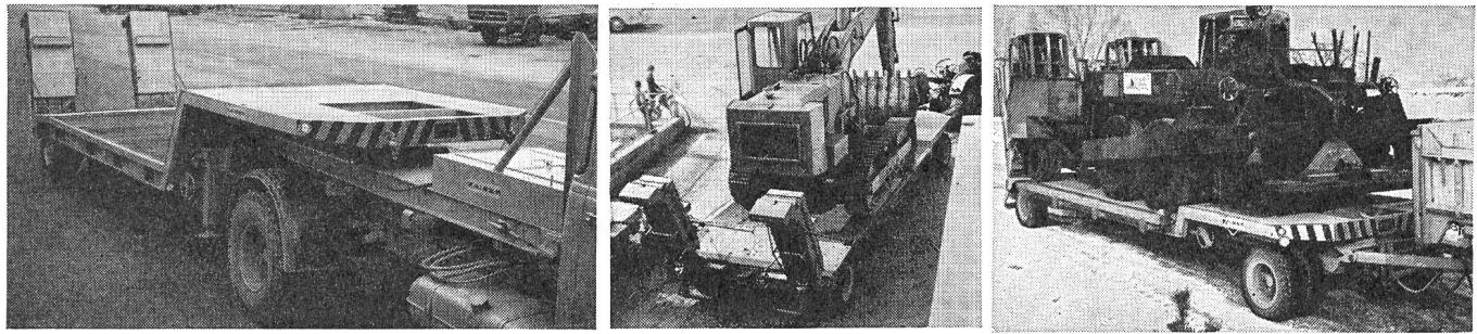
Dank 15jähriger Erfahrung sind unsere Tiefganganhänger Spitzenprodukte mit besonderen Vorzügen: Niedere Bauart, kleine Abkröpfung, geringes Eigengewicht, waltungsfreie Gummifederung, hydraulisch klappbare Auffahrtsrampen, typengeprüft
