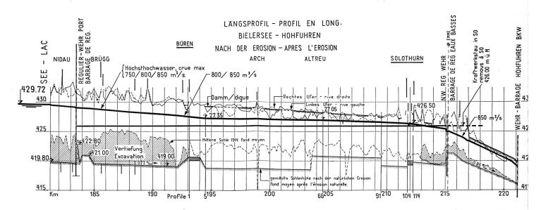
Abb. 3. Längsprofil der Aare vom Bielersee bis Hohfuhren. Der starke Gefällswechsel im Hochwasserspiegel unterhalb Solothurn lässt den Engpass des «Emmeriegels» erkennen. Die Schraffur stellt die durch die II. JGK ausgeführten Sohlenvertiefungen im Nidau-Büren-Kanal und im «Emmeriegel» zwischen Solothurn und Hohfuhren dar. Zwischen Büren und Solothurn ist die durch die natürliche Sohlenerosion zu erwartende Sohlenabsenkung eingetragen
