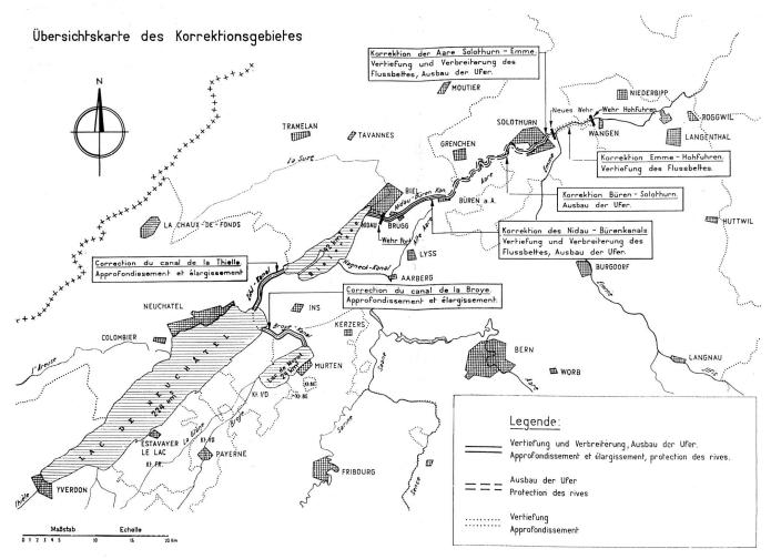
Abb. 2. Uebersicht über das Korrektionsprojekt. Auf der Karte ist noch das Regulierwehr oberhalb der Emmemündung dargestellt, an dessen Stelle das KW Flumenthal unterhalb der Emmemündung getreten ist. Mit dem Bau des KW Neu-Bannwil ist auch das alte Wehr Hohfuhren verschwunden
