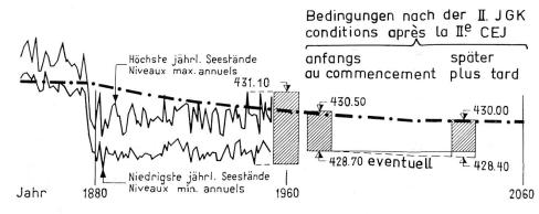
Abb. 1. Die Absenkung der Wasserstände in den Seen durch die I. JGK (ca. 1880) und als deren Folge das Absinken der «Ueberschwemmungsgrenze» (-.--). Seit den vierziger Jahren stechen die Hochwasserstände immer häufiger über die Ueberschwemmungsgrenze hinaus
