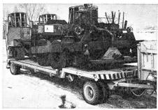
Dank 15jähriger Erfahrung sind unsere Tiefganganhänger Spitzenprodukte mit besonderen Vorzügen: Niedere Bauart, kleine Abkröpfung, geringes Eigengewicht, wartungsfreie Gummifederung, hydraulisch klappbare Auffahrtsrampen, typengeprüft
