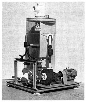
Abb. 3. FAV-Reaktor für 15  $\,\mathrm{m^3/h}$  Durchsatzleistung. Grundfläche 120  $\times$  140 cm, Höhe 200 cm
