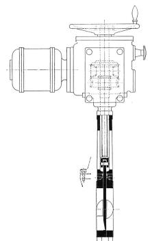
Abb. 2. Elektrische Fernsteuerung
