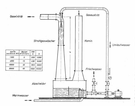
Abb. 4. Schema eines Körting-Strahlgaswäschers mit Leistungstabelle
