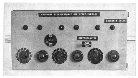
Abb. 1. Versuchsgerät zur Ozonentwicklung (Photo D. Suter, Zürich)
