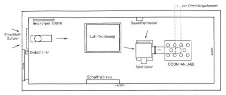
Abb. 2. Schema einer Industrie-Ozon-Anlage, System M. Blatter, Basel
