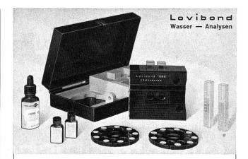
Das «LOVIBOND 1000»-Komparator-Programm ermöglicht über 60 verschiedene Wasseranalysen. Meistens werden diese Untersuchungen im Labor durchgeführt, aber häufig muss auch im Feld an Ort und Stelle gearbeitet werden. Dazu bieten wir komplette Feldausrüstungen, die alle erfoderlichen Geräte und Chemikalien für die entsprechenden Tests enthalten.
