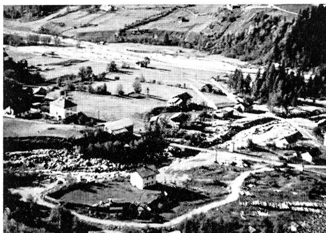
Mörschach im Mölltal: Mitten im Hauptgefährdungsbereich des Astengrabens stehen einige neuere Wohnhäuser (Pfeile), die beim Ausbruch einer Mure stark beschädigt wurden. Nach der Instandstellung (teilweise sogar Neubau!) ist die Gefährdung nicht kleiner geworden. Ältere, vor allem bäuerliche Anwesen stehen ausserhalb des grössten Gefahrenbereiches
