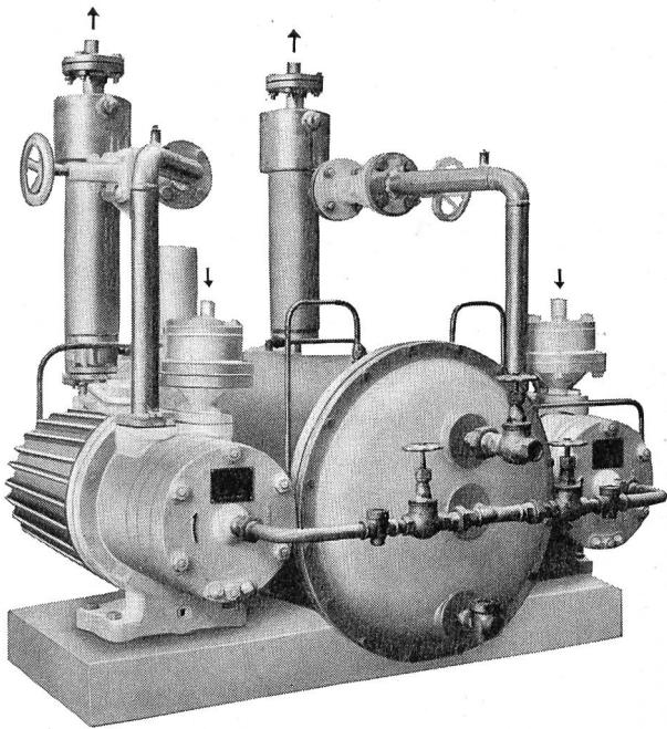
Wasserringvakuumpumpen mit Spaltrohr-Motoren
