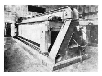
Fig. 6. Station d'épuration des eaux usées de Vidy. Station de déshydratation: Presse à filtre.
