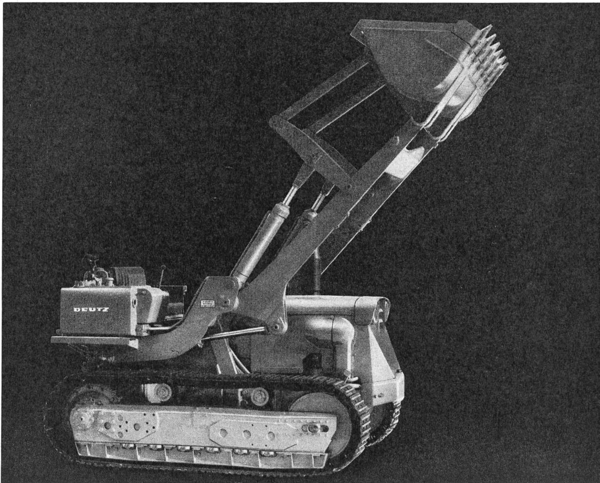
Mit unter Last schaltbarem Wendegetriebe
