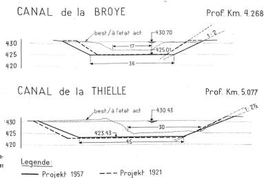
Abb. 11. Die erforderliche Vertiefung und Erweiterung der Verbindungskanäle Broye und Zihl (schraffierte Fläche) verglichen mit der Beurteilung von Ing. Peter 1921.
