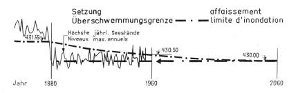
Abb. 3. Die strichpunktierte Linie zeigt die Höhen der an den Murten- und Neuenburgersee anstossenden Ebenen des Grossen Mooses und deren Senkung im Verlauf der Jahre, die Setzung.
