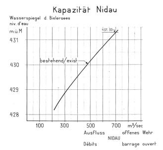
Abb. 7. Das Ausflussvermögen aus dem Bielersee in Nidau im bestehenden Zustand und bei offenem Wehr Port in Abhängigkeit vom Seestand im Bielersee.
