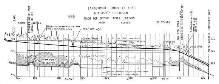
Abb. 9. Die zukünftigen Längsprofile der mittleren Sohle und des höchsten Wasserspiegels der Aare vom Bielersee bis zum Wehr Hohfuhren. Die schraffierten Flächen zeigen die Vertiefurg des Nidau—Büren-Kanals und unterhalb Solothurn das Entfernen des «Emmeriegels». Die schraffierte Sohle zwischen Büren und der Emmemündung deutet die erwartete natürliche Erosion an. Das Wehr des Kraftwerks Flumenthal, mit Stau 426,00 Meter über Meer in Solothurn gemessen, wird bei etwa km 217,3 gebaut werden.
