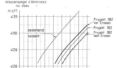
Abb. 10. Das Ausflussvermögen in Nidau bei offenem Wehr Port vor und nach der zweiten Korrektion und die weitere Steigerung durch die natürliche Erosion. Fein gestrichelt die von Ing. Peter 1921 als erforderlich erachtete Vergrösserung des Ausflussvermögens.
