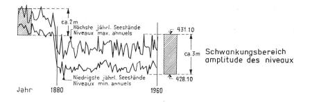
Abb. 2. Die höchsten und tiefsten Jahresstände und deren Absenkung durch die erste Korrektion (Mittel der drei Seen).
