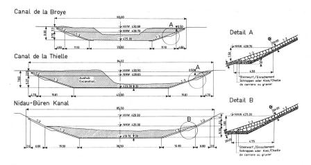
Abb. 14. Die technischen Querprofile der Zihl und Nidau— Büren.
