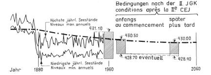
Abb. 6. Die durch die Setzungen der Ebenen und die gewünschte Hebung der niedrigsten Seespiegel gegebenen Bedingungen über den zukünftigen Schwankungsbereich nach der II. JGK (Mittel der drei Seen).
