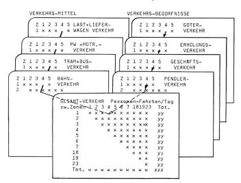
Abb. 2. Dreiecktafeln: In der Verkehrsbilanz werden einerseits alle Verkehrsbedürfnisse berechnet, und anderseits, für den heutigen Zustand, mit den gemessenen Verkehrsmittelbelastungen verglichen, oder, im Hinblick auf die Zukunft, auf die projektierten Verkehrsmittel verteilt.
